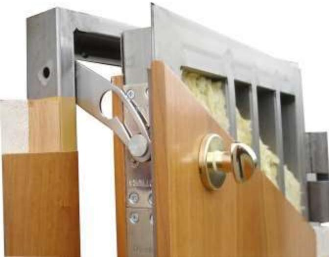
Limitador de apertura de seguridad. Un pasador de acero de 18 mm engancha en chapa de acero atornillada al marco, lo que le permite abrir parcialmente la puerta con total seguridad cuando reciba alguna visita dudosa, evitando un posible intento de irrumpir en la entrada.
